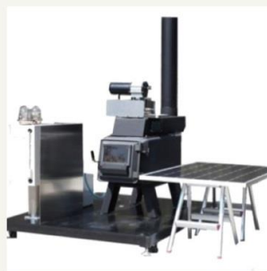
薪ストーブ・スターリング発電システム (株)ジェー・ピー・イー
