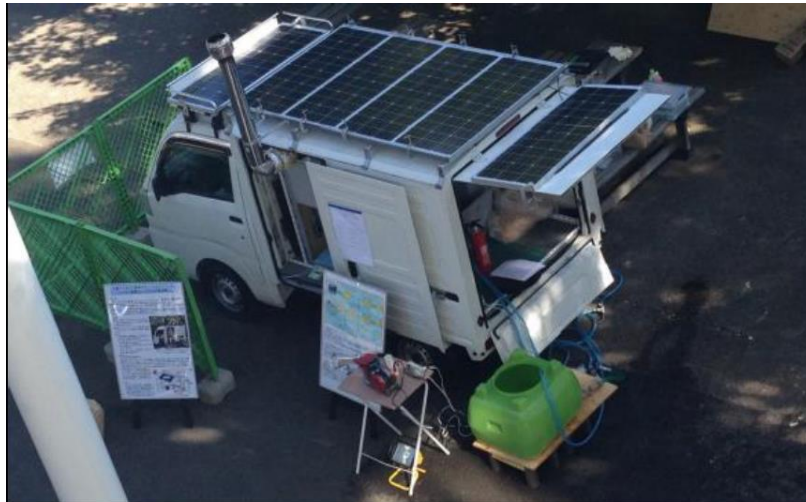
スターリングエンジンとソーラー発電のハイブリッド電源車
